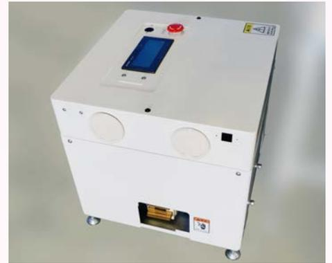
バッテリー交換の手間を省き、自動充電により効率的なシステム運用を可能にします。光通信を介して行先指示が出来る充実機能を装備。
